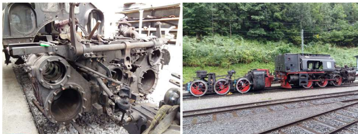
Les 2 châssis découplés, une vision très inhabituelle d'une locomotive à vapeur...
