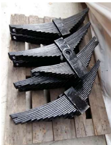
Les ressorts à lames ont été révisés et les ressorts hélicoïdaux ont été intégralement remplacés.
