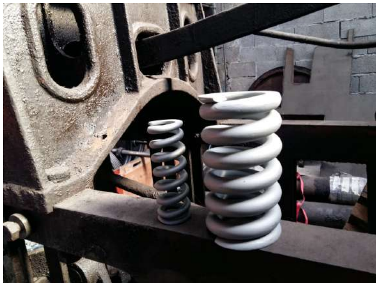
Les ressorts à lames ont été révisés et les ressorts hélicoïdaux ont été intégralement remplacés.
